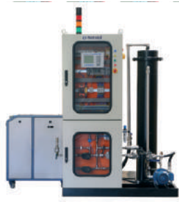
Dosificador de aceite lubricante para líneas de montaje
